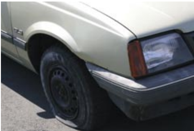
Bilder 2 und 3: Das Ergebnis von drei Anfahrtdemonstrationen: ein platter Reifen und Gummiabrieb an der Betonschutzwand. Wenn alle Unfälle auf der Autobahn so glimpflich verlaufen ...
