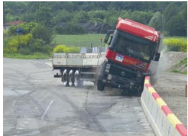
Bild 2: Durch Anprallprüfungen mit Fahrzeugen unterschiedlicher Masse wird die Durchbruchssicherheit der FRS getestet
